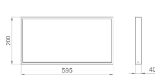
Рис.№1 Размеры светильника
