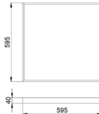
Рис.№1 Размеры светильника
